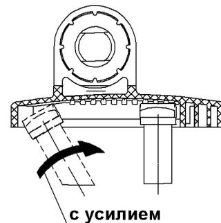
Шляпка болта эксцентрична, поэтому позволяет устанавливать сиденье на унитазы с разным межосевым расстоянием С = 158; 160; 162 мм (Вид А см. на обороте)
