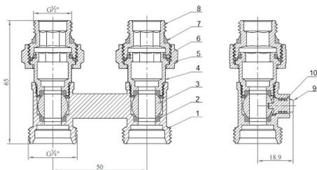
Рис.2 Габаритные размеры углового шарового узла подключения радиатора.
